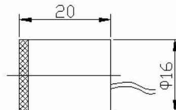
**Активные Преобразователи Пьезоэлектрические ультразвуковые АПП 100 -12** предназначены для:
